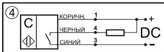
Схема соединения Нормально-разомкнутый контакт
