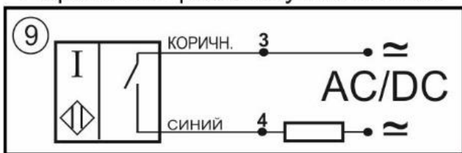
Схема соединения Нормально-разомкнутый контакт
