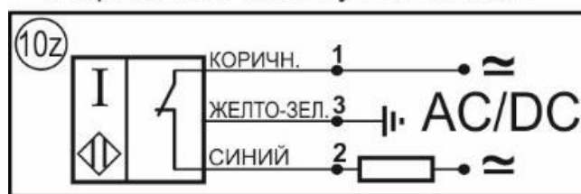
Цоколевка клеммной колодки
