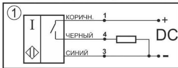
Схема соединения Нормально-разомкнутый контакт
