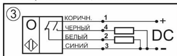
Схема соединения Переключающий контакт
