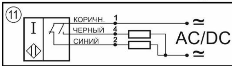
Схема соединения активный выход должен быть под нагрузкой
