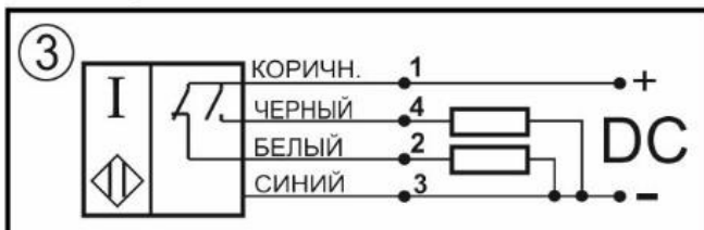
Схема соединения Переключающий контакт
