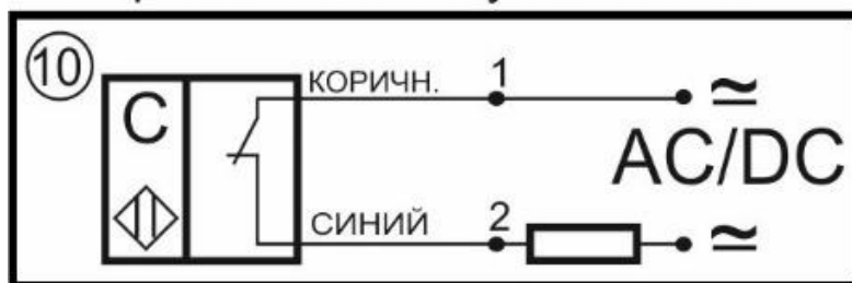
Схема соединения Нормально-замкнутый контакт
