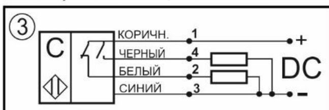
Схема соединения Переключающий контакт
