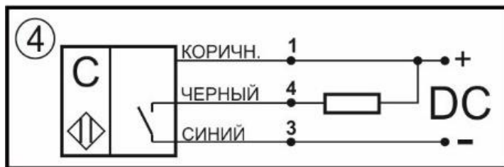
Схема соединения Нормально-разомкнутый контакт
